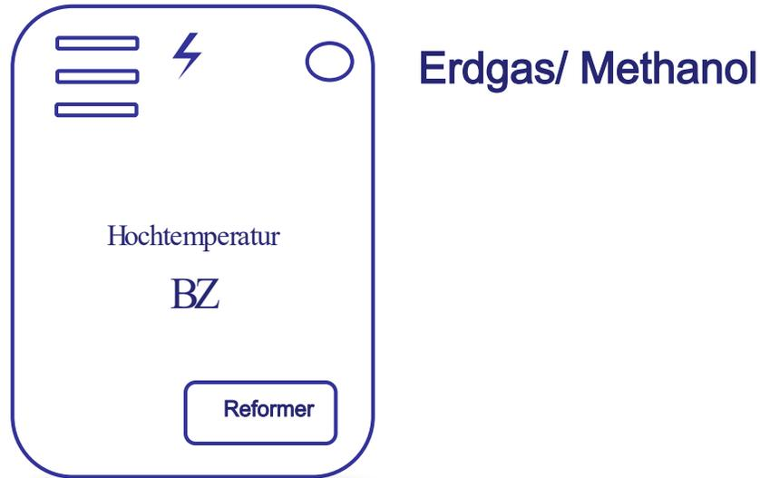
Leistung von  $P = 5\text{kW}$  bis  $500\text{KW}$  möglich
